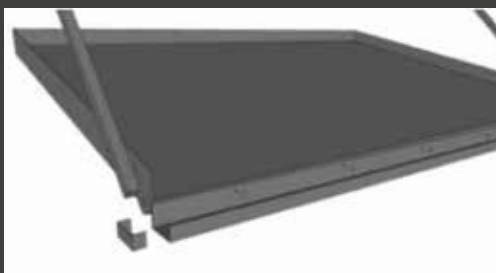
Rännin vedenohjauksen toisen pään sulkeminen
